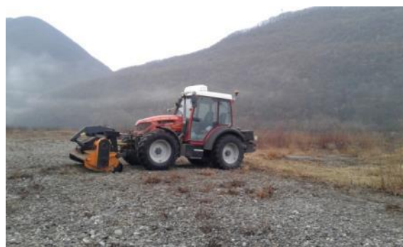
Équipement de broyage dans le lit (© Grenoble-Alpes Métropole, RNR).
